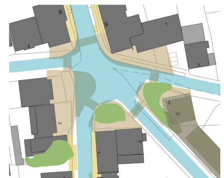
Abb. Skizze „Reduzierung der Straßenfläche durch „kompakter“ Knoten“, Variante 2, blau markiert die bestehenden Straßenflächen, rockinger und schneider, Planungsbüro Skorka, 2012
