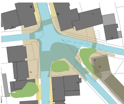
Abb. Skizze „Reduzierung der Straßenfläche durch entzerrte Straßenführung“, blau markiert die bestehenden Straßenflächen, rockinger und schneider, Planungsbüro Skorka, 2012
