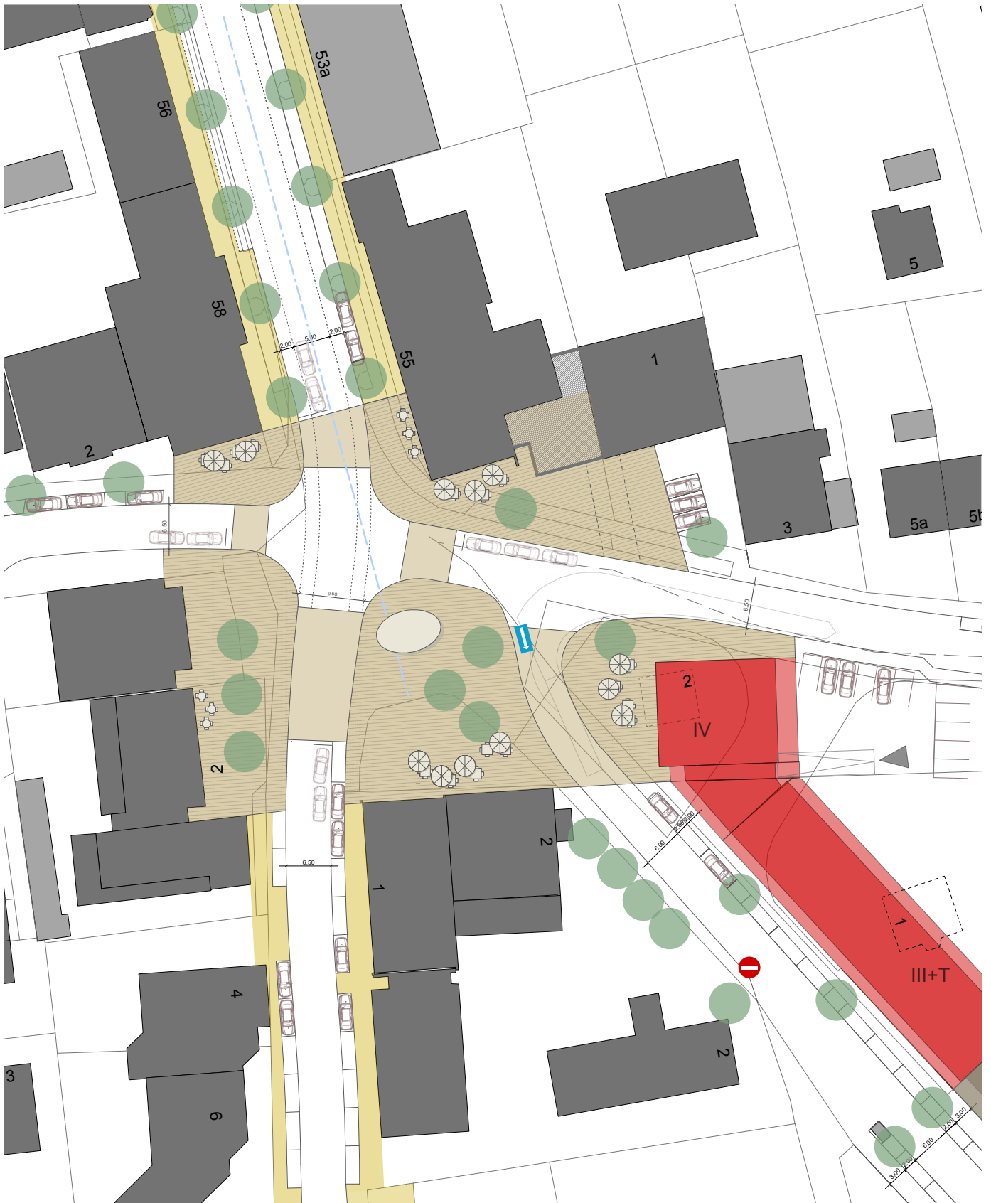
Abb. Skizze „Ausbildung des Knotenpunktes am „Kleiner Stachus“ als „entzerrter“ Knoten, Variante 4“, rockinger und schneider, Planungsbüro Skorka, 2012
