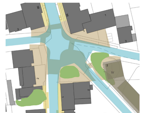
Abb. Skizze oben „Reduzierung der Straßenfläche durch entzerrte Straßenführung, Variante 4“, blau markiert die bestehenden Straßenflächen, rockinger und schneider, Planungsbüro Skorka, 2012
