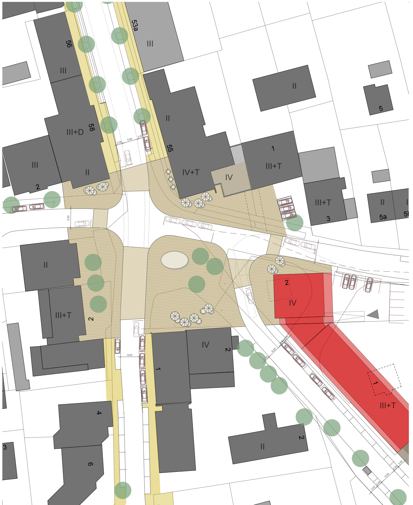
Abb. Skizze „Ausbildung des Knotenpunktes am „Kleinen Stachus“ als „entzerrter“ Knoten, Variante 1“, rockinger und schneider, Planungsbüro Skorka, 2012
