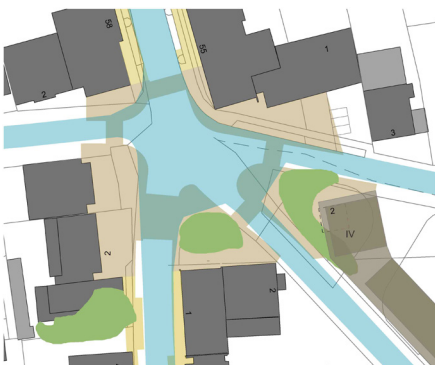
Abb. Skizze oben „Reduzierung der Straßenfläche durch kompakte Straßenführung, Variante1“, blau markiert die bestehenden Straßenflächen, rockinger und schneider, Planungsbüro Skorka, 2012
