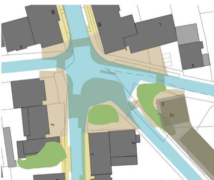
Abb. Skizze oben „Reduzierung der Straßenfläche durch entzerrte Straßenführung, Einbahnregelung Otto-Wagner-Straße“, blau markiert die bestehenden Straßenflächen, rockinger und schneider, Planungsbüro Skorka, 2012
