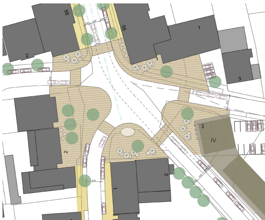
Abb. Skizze „Reduzierung der Straßenfläche durch „kompakter“ Knoten“, Variante 2, blau markiert die bestehenden Straßenflächen, rockinger und schneider, Planungsbüro Skorka, 2012
