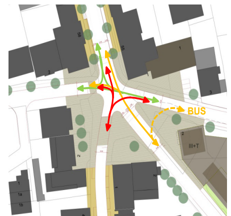
Abb. Skizze „reduzierte Abbiegemöglichkeit beim kompakten Knoten“, rockinger und schneider, Planungsbüro Skorka, 2012
