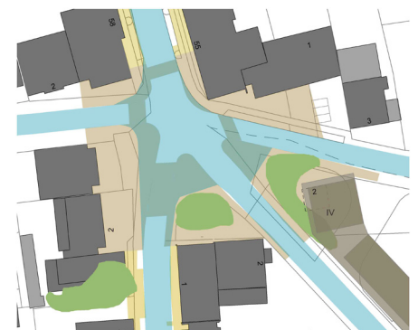
Abb. Skizze „Reduzierung der Straßenfläche durch „kompakte“ Straßenführung“, blau markiert die bestehenden Straßenflächen, rockinger und schneider, Planungsbüro Skorka, 2012
