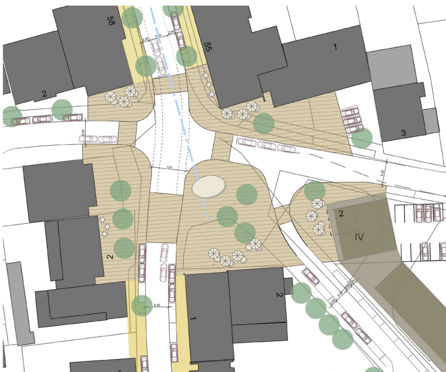
Abb. Skizze oben „Reduzierung der Straßenfläche durch entzerrte Straßenführung, Variante 4“, blau markiert die bestehenden Straßenflächen, rockinger und schneider, Planungsbüro Skorka, 2012
